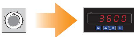
アナログ信号で制御するモーターなどの速度調整用可変抵抗器を回す感覚で希望の単位に換算した数値をデジタルで設定操作できます。
